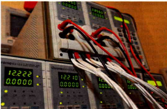
Alle Netzteile müssen an dieser Chroma 63103 ihre Leistungsfähigkeit beweisen und werden mit den Lastzuständen 10, 20, 50, 80 und 100 Prozent getestet.
