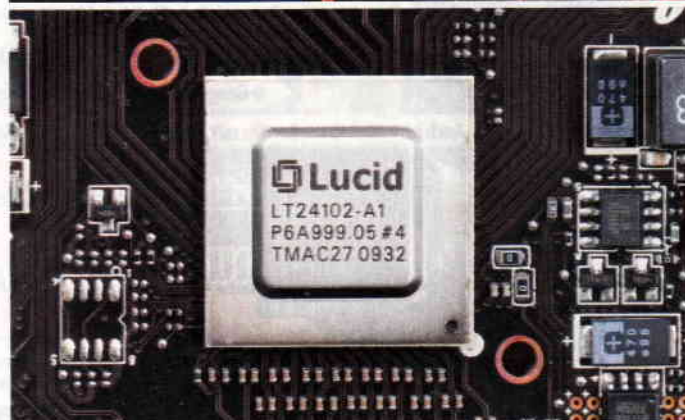
Auf dem Asus IV Extreme (oben) sitzt ein Hydra 200, genauer der LT24102-A1 (unten). Der Hydra-Chip erlaubt es, Geforce- und Radeon-Karten im Multi-GPU-Betrieb zu koppeln oder beide Hersteller zu mischen. Die Treiberoberfläche ist selbsterklärend (Mitte).
