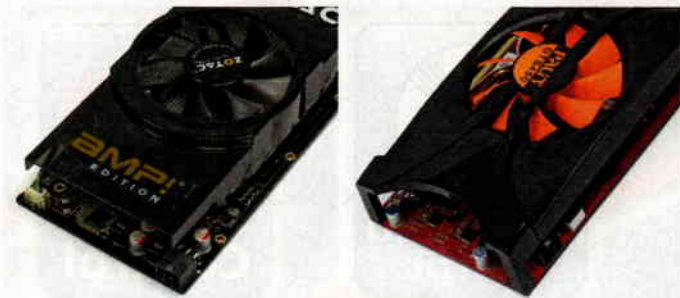
Wichtig für enge PC-Gehäuse: Einige Karten führen den PCI-E-Stromanschluss nach hinten (z. B. Zotac, MSI, Evga) oder nach oben (z. B. Gainward, Palit, Asus) heraus.
