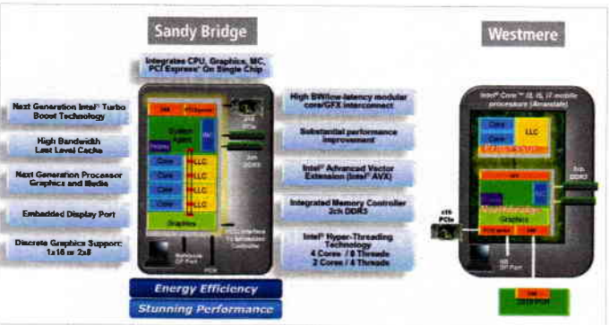
Bilder: Intel Sandy Bridge wird einige Designänderungen bringen, darunter eine Vektor-Befehls-satzerweiterung und natürlich einen On-Die-Grafikkern.
