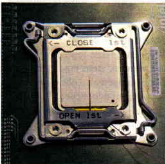
Zur Bestimmung der Kühlleistung kommen regelbare Prozessor-Dummys zum Einsatz. Intel stellt Kühlerherstellern CPUs mit modifiziertem Heatspreader zur Verfügung.
