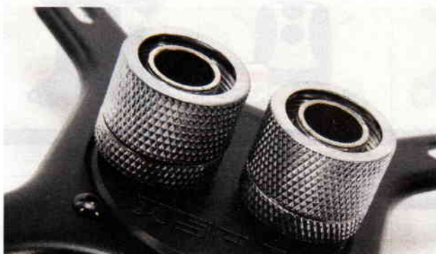
Wünschenswert: Ein Mittenabstand von mehr als 22 mm gewährt hohe Kompatibilität zu großen Anschlüssen wie den beliebten 16/10er Schraubtüllen.
