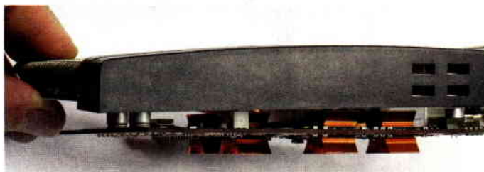
Wie Sie sehen, sehen Sie nichts: Die Powercolor HD 5750 Go Green kommt ohne zusätzlichen Stromanschluss aus und kann daher das Aufrüsten des Netzteils ersparen.
