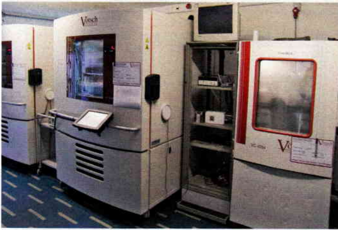
Mittels spezieller Klimaschränke wird getestet, ob das Material der Wasserkühlungen auch Extremtemperaturen unterhalb des Gefrierpunkts trotzten kann.
