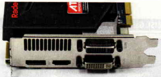
Mit vier gleichzeitig nutzbaren Ausgängen erweitert die HD 5770 Flex das Eyefinity-Repertoire. Der Trick: Ein DP-Controller wird per Zusatzchip auf SL-DVI (oben) umgesetzt.
