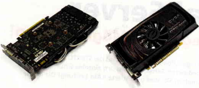
Die Asus-Karte (links) verfügt als Einzige über eine VRM-Kühlung per Aluprofil und rückwärtigem Blech. Evga (rechts) hält sich hingegen komplett ans Referenzdesign.
