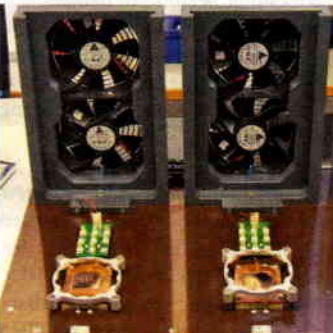
Zur Bestimmung der Kühlleistung kommen regelbare Prozessor-Dummys zum Einsatz. Intel stellt Kühlerherstellern CPUs mit modifiziertem Heatspreader zur Verfügung.
