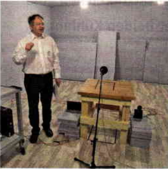
Im Lautstärkemesslabor kann der Schalldruckpegel zweier Kühlungen direkt miteinander verglichen werden. Zur Grafikkartenkühlung existieren einzelne Prototypen.
